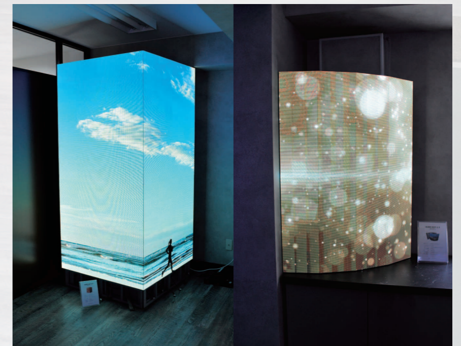
▲ 90°およびR面設置に対応したCOB型LEDディスプレイ。いずれもピクセルピッチ2.5mm。
