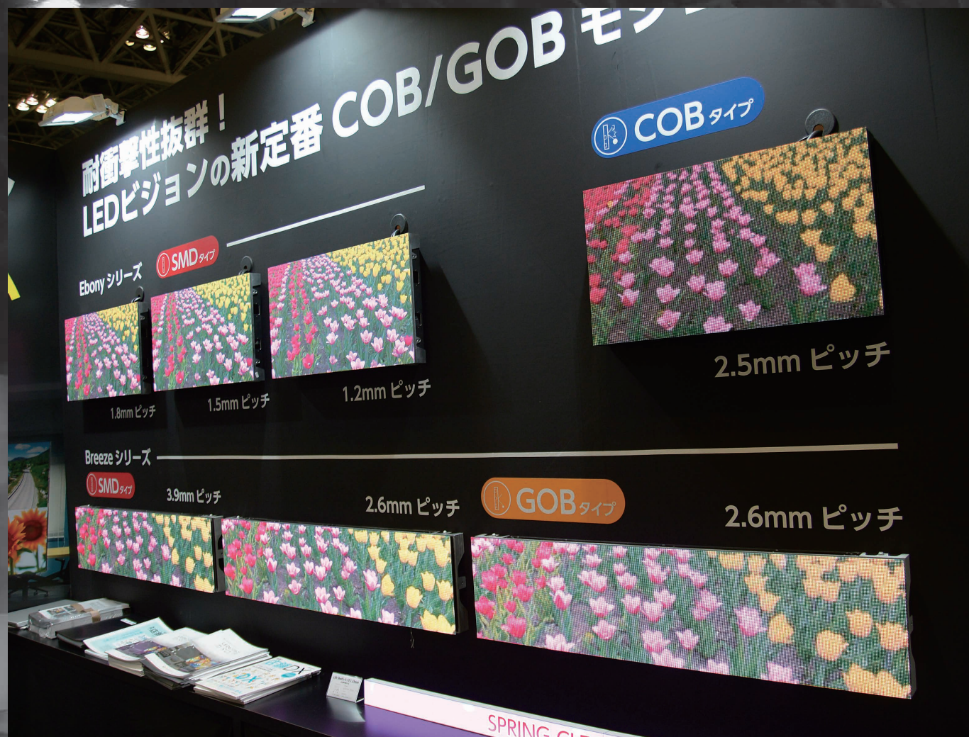
SMD (表面実装) と COB (チップオンボード)、GOB (グルーオンボード) の3つのタイプのLEDビジョンを比較展示。
